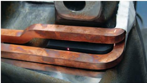
Bauteil mit angepasstem Induktor und Pyrometermessfleck zur Temperaturregelung mit einem MFG 15 DA
