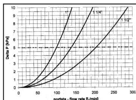
**Perdite di carico del filtro completo:** Le cadute di pressione nei filtri completi sono riferite a olio minerale avente massa volumica di 860 kg/m<sup>3</sup> e viscosità cinematica di 30 mm<sup>2</sup>/s (cSt). La caduta di pressione massima a filtro pulito deve essere ≤ 5 kPa.
