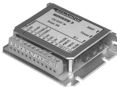
Ce petit variateur économique permet le contrôle de la vitesse d'un moteur à courant continu jusqu'à 24V 3A. Le principe du découpage de la tension d'alimentation permet d'obtenir un encombrement et un échauffement réduits. Son boîtier à multiples fixations le rend facile à intégrer dans tout coffret.
