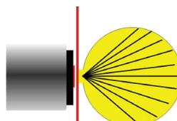
MA35-UK-CA10 - für die Transmissionsmessung
