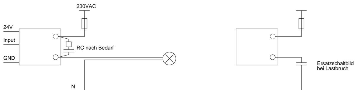
Deshalb sind die Kabellängen nach Tabelle 7a nicht zu überschreiten. Bei der Einschätzung der Kabellängen geht die Tabelle vom schlimmsten Fall aus, welcher dann eintritt, wenn die Kabel mit kleinstmöglichem Abstand im Kabelkanal verlegt sind. In der Praxis treten solche ungünstig kleinste Abstände nicht auf. Lediglich für den Fall, dass die Verbindung vom Relais zur Last mit einem 3-adrigen Kabel nx0,75 ausgeführt wird, muss mit diesen Extremwerten gerechnet werden.
