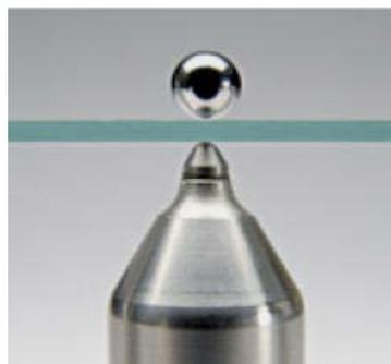
Detalle de medición en una muestra de vidrio con bola de acero de 2,5 mm.
