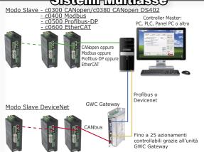
Controllo degli azionamenti tramite comandi da Controllore Master. Adatto per Sistemi Multiasse (fino a 127 azionamenti). Integra tutte le Funzionalità del Modulo Power Motion che assicura perfetta Sincronia tra gli Assi e Riduce il carico di Lavoro del Controllore Maste
