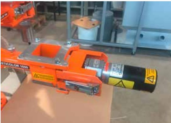
Demontieren Sie die Motoranbau-Einheit G 1/ G 2 durch Lösen der beiden Spannverschlüsse.
