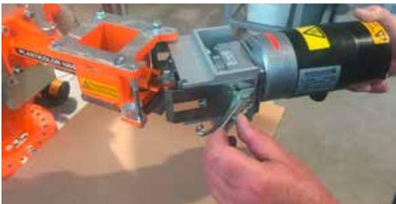
Die Motorkonsole zunächst auf einer Seite mit dem Spannhaken befestigen.
