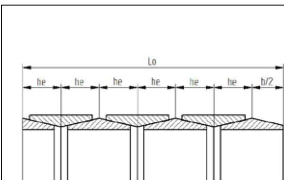
Bild 8: Reibungsfeder mit 6 Elementen, Enden 1 IR + 1 HIR
