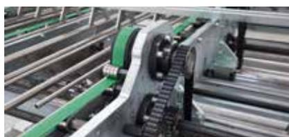
Unsere Spannsätze werden weltweit in den unterschiedlichsten Verpackungsmaschinen verbaut. Beispielsweise zur Befestigung von Riemenscheiben sowie zur Beförderung von Waren innerhalb der Maschinen. Darüber hinaus kommen auch Schrumpfscheiben und Wellenkupplungen zum Einsatz.
