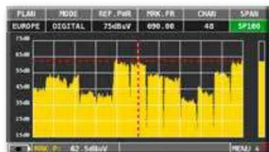
Spettro TV span 100 MHz
