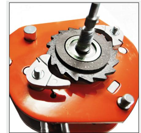
Die Position der Sperrklinken reduziert den freien Weg in der Verzahnung auf ein Minimum, weit unter dem im BS 4898:1973 geforderten Wert. Beim Heben werden die Sperrklinken sehr schnell und über einen kurzen Weg in den Grund der Verzahnung zurückgeführt. Hierdurch kann die Positionierung der Last noch feinfühler erfolgen.
