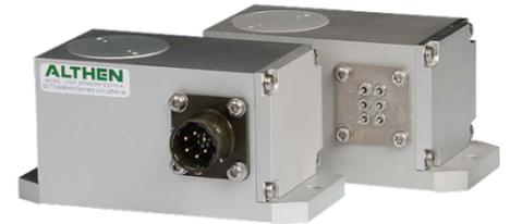
Die Servo-Inklinometer der Serie ALSO arbeiten hoch-präzise und eignen sich für eine Vielzahl an industriellen Anwendungen. Es stehen Modelle mit unterschiedlichen Neigungswinkeln, mit Spannungsausgang oder mit 4-20mA-Ausgang (Version L) zur Verfügung. Der elektrische Anschluss kann wahlweise über einen 6-poligen Stecker (ALSOC) oder über Lötstifte (ALSOP) erfolgen.
